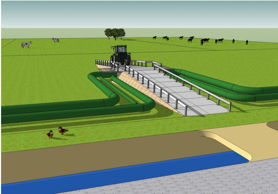
Figuur 2.2 Overzicht van horizontale expansiebochten met toegang tot perceel.
