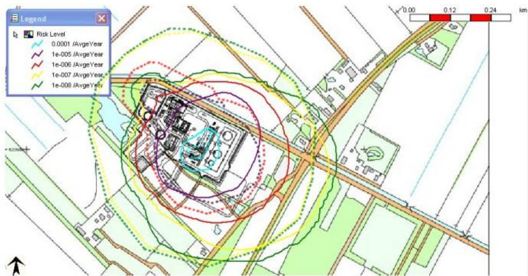
Figuur 2.2 Vergelijking Plaatsgebonden Risico's [Doorgetrokken lijnen = huidige contouren; Stippellijnen = 2006 contouren].
